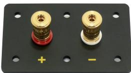
**High-End Terminal** mit stabiler Montageplatte und extrem hochwertigen, 5-Schicht-supravergoldeten WBT-Klemmen mit frei drehbarem Anschlussdruckstück. Für Anschlussleitungen mit einem Querschnitt von 1,5 bis 10 Quadratmillimetern, die bei Spitzenströmen bis zu 200 A einen sicheren Kontakt garantieren.
